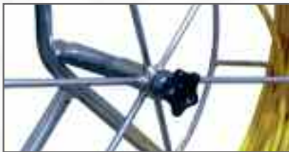
Frein contrôlant le glissement de la canne
